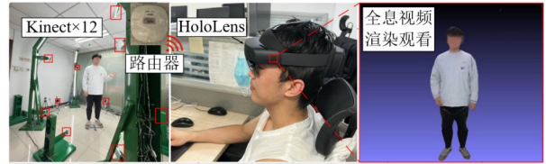
图 5 VVSTiler 全息视频流通信原型系统
